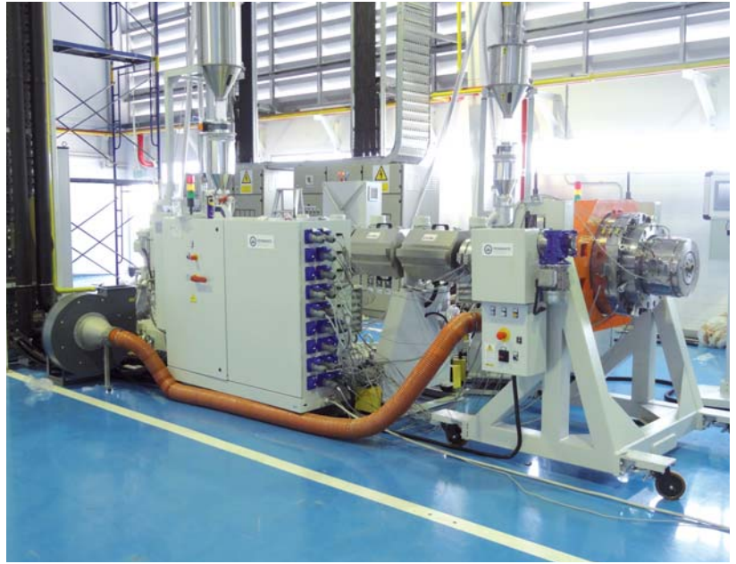
Экструдер VEGA 75.37 с головкой VENUS 400 и системой охлаждения РАС для эффективного производства труб
